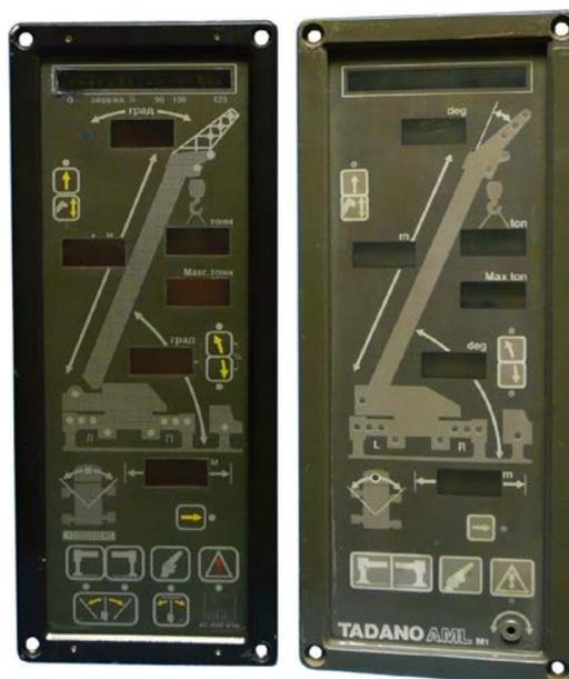
**Слева – АС-АОГ-01 выпуска 1990-2002г, справа – прототип, TADANO AML-M1**
