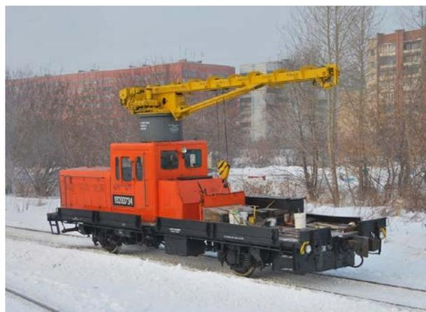
Крановые установки дрезин (ДГКу) и мотовозов (МПТ) с балочной стрелой
