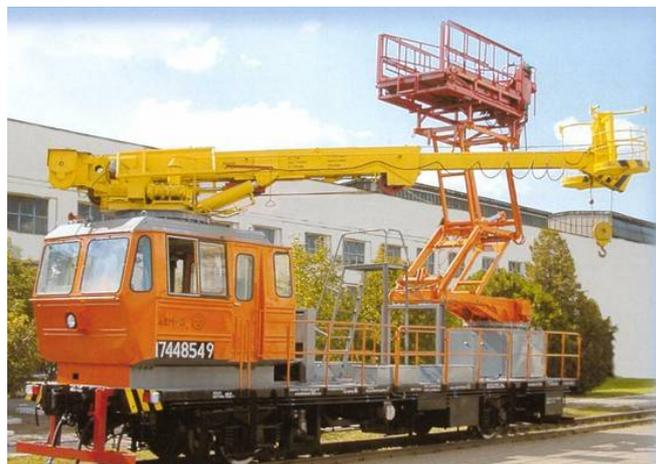
**Крановые установки мотрис (АДМ) и мотовозов (МПТ) с телескопической стрелой**
