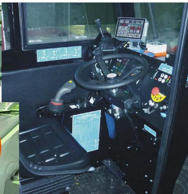
Пример оборудования цифровым беспроводным каналом связи электропневмоколесного крана Valla.
