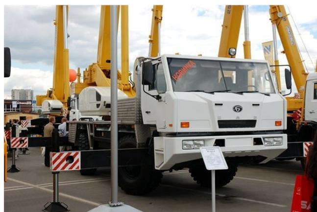
**КС-59712-2 с системой АС-АОГ-01м+ исполнение "Г"**
