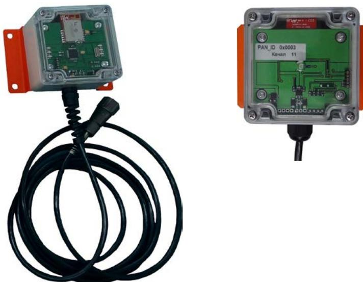
**АС-РК-01. Приемо-передатчик беспроводного канала связи**
