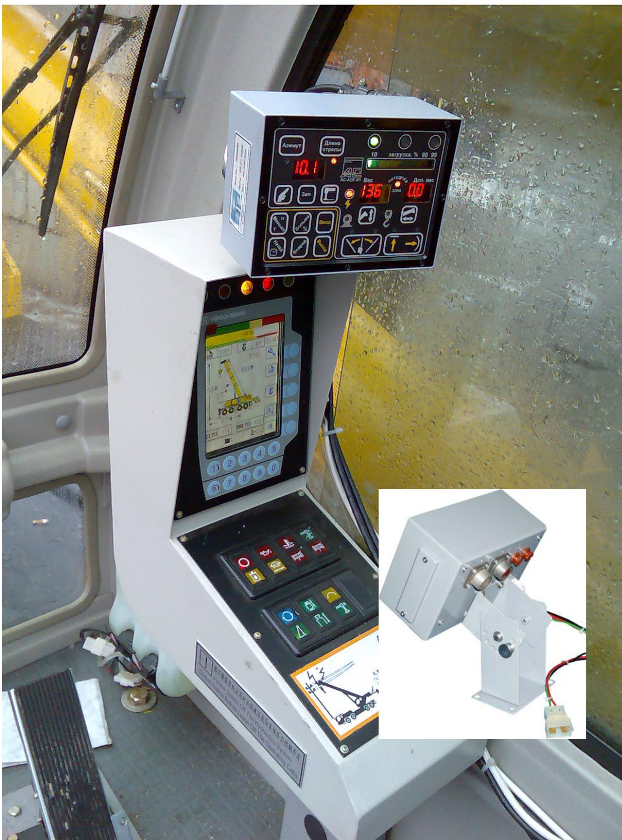
**Кабина крана QY25K5 оснащенного системой АС-АОГ-01м+ исполнение "В".**
